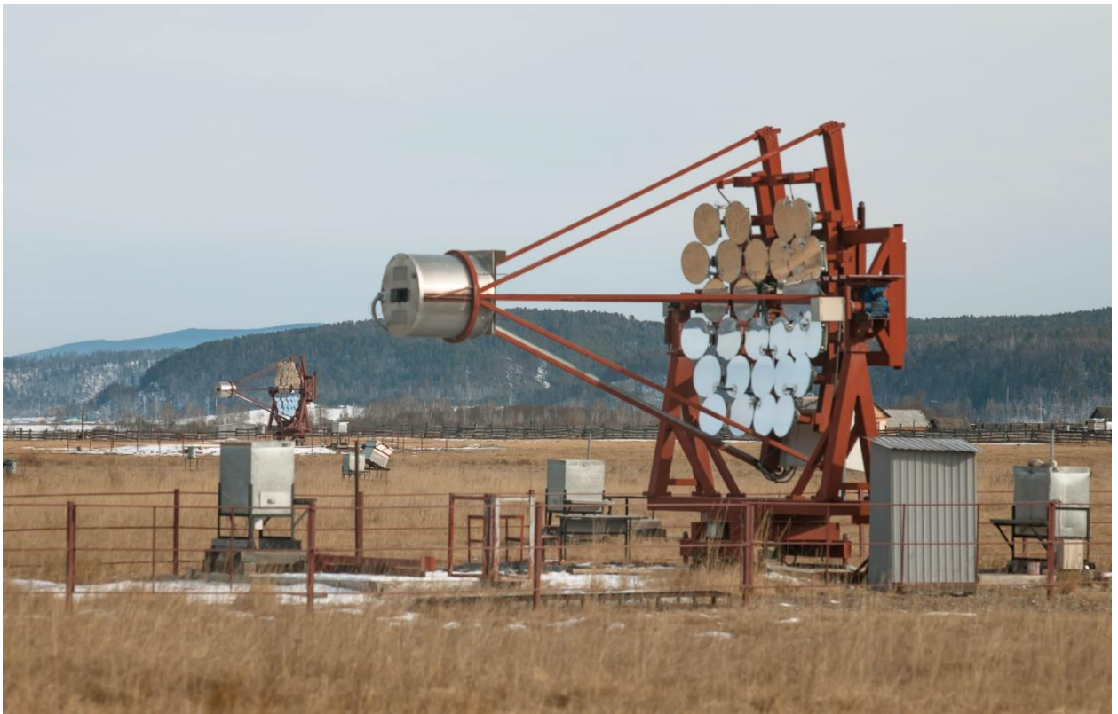
Рисунок 9.4 – Атмосферный черенковский телескоп установки TAIGA-IACT.
