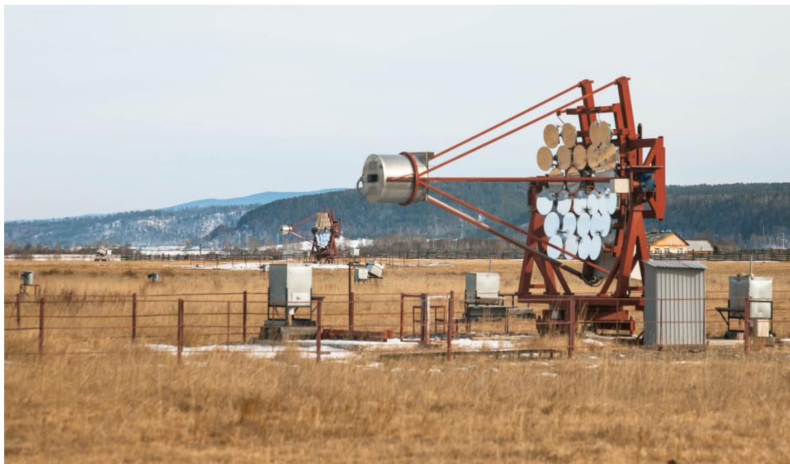
Рисунок 1.10 – Два атмосферных черенковских телескопа установки TAIGA-IACT.
