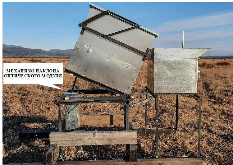
Рисунок 1.5 –Механизм для изменения наклон оптических станций установки TAIGA-HiSCORE относительно вертикальной оси.
